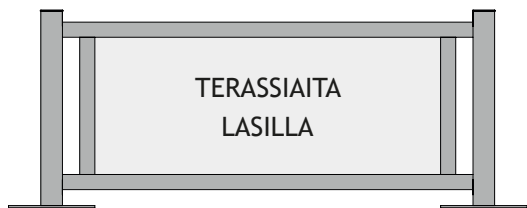
Aloitusmoduuli 2000 x 900 mm Moduulin osat: jalat, muovikannet ja 8 mm lasi
