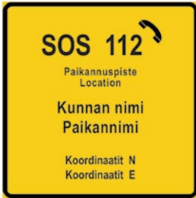
Kuva 26. Muilla kuin tieliikennelain alaisilla reiteillä käytettävä paikannuspistemerkki. Merkki on keltainen ja siinä on musta reunaviiva.
